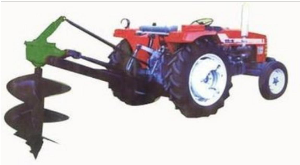
前置式挖坑机的优点：高效:挖坑机动力强劲，直径五十公分、深度两米的土坑大概在1分钟内便能完成，效率是传统人工挖坑方式的百倍以上，是后置式挖坑设备的5-7倍；操作简捷:挖坑机实现了驾驶与操作的一体化，1-2名操作人员可顺利完成各种土坑的挖钻工作；作业质量高:该设备采用钻头前置式设计，较后置式更易找准钻点。采用度钻头，抗扭、抗拉螺旋钻杆，中心定位，挖出的土坑直、实，坑内土余量少，比较大深度能达到3.5米；适应性强:由于采用拖拉机或挖掘机为该设备制造平台，该类型设备具备较强的越野性能，丘陵、山地等复杂地形均能良好适应，能在黄土层、黏土层、含鹅卵石砂砾土层、风化岩土层、冻土层、建筑回填垃圾、全沙层、生活垃圾层等大部分土质上施工作业；应用范围广:该设备可广泛应用于电力电信工程、市政工程、绿化植树工程、建筑施工工程、太阳能光伏发电工程等。烟台供应机械设备供应商潍坊机械设备哪家好？
